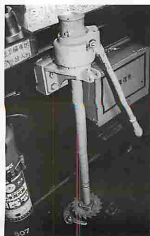
※手ブレーキは自動車の サイドブレーキにあたる ※前照灯は自動車のヘッド ライトにあたる
